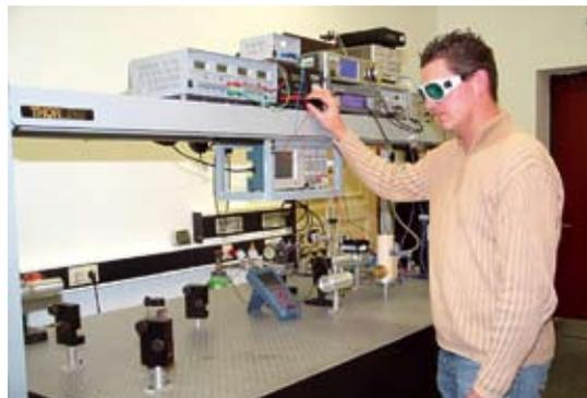
sitivität und Selektivität verfügen. Die von Herrn Dr. Germer für die NO-Detektion eingesetzte photoakustische Spektroskopie ist ein laserbasiertes Verfahren, das die Umwandlung absorbierter elektromagnetischer Strahlung in eine akustische Schallwelle nutzt. Als Strahlungsquelle diente ein Quantenkaskadenlaser. Die NASA ent-
